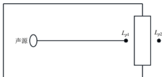
图 5.3-1 室内声源等效为室外声源图例
